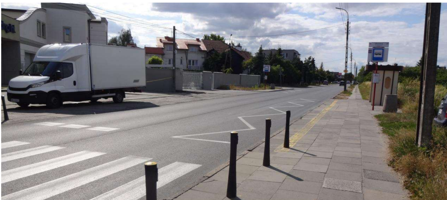
Przykład 4. Autobus stojący na przystanku wyznaczonym na jezdni tuż za przejściem, ogranicza widoczność. Pieszy wychodzi z za autobusu pod jadący przeciwnym pasem pojazd. Niepełne oznakowanie poziome.
