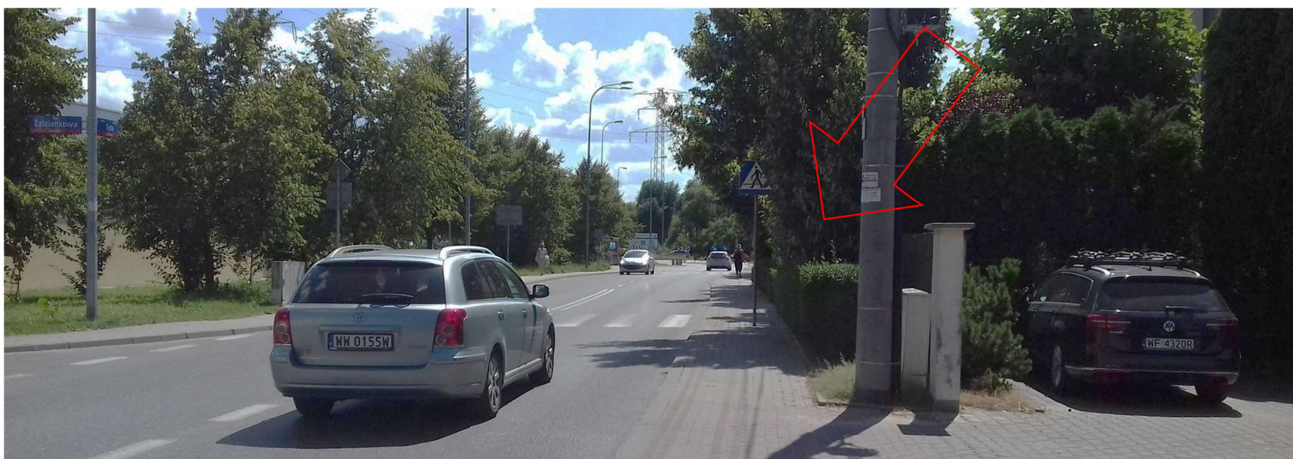
Przykład 7. Cień drzew powoduje, że pieszy zbliżający się do przejścia i wchodzący na przejście nie jest widoczny dla kierowcy. Zieleń ogranicza widoczność oznakowania pionowego.
